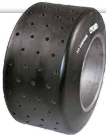
▲ El dibujo de la rueda puede causar desprendimientos que pueden sacrificar la seguridad y la productividad total de la rueda. Elija ruedas de poliuretano ya que ayudan a obtener tracción en superficies húmedas y resbaladizas. El dibujo con patrón de agujeros permite a los operadores experimentar mejor tracción, mejor frenada, aumento de productividad y mejora la seguridad.
