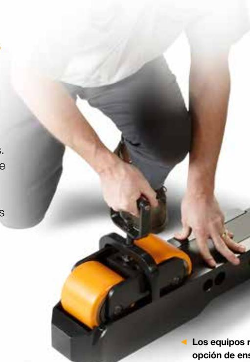
◀ Los equipos retráctiles de Crown ofrecen una opción de ensamble de RUEDAS DE CARGA CON SISTEMA DE CAMBIO RÁPIDO patentado, que permite a los técnicos reemplazar ruedas de carga en 2 ½ minutos en comparación con un reemplazo tradicional de 30-40 minutos de tiempo.
